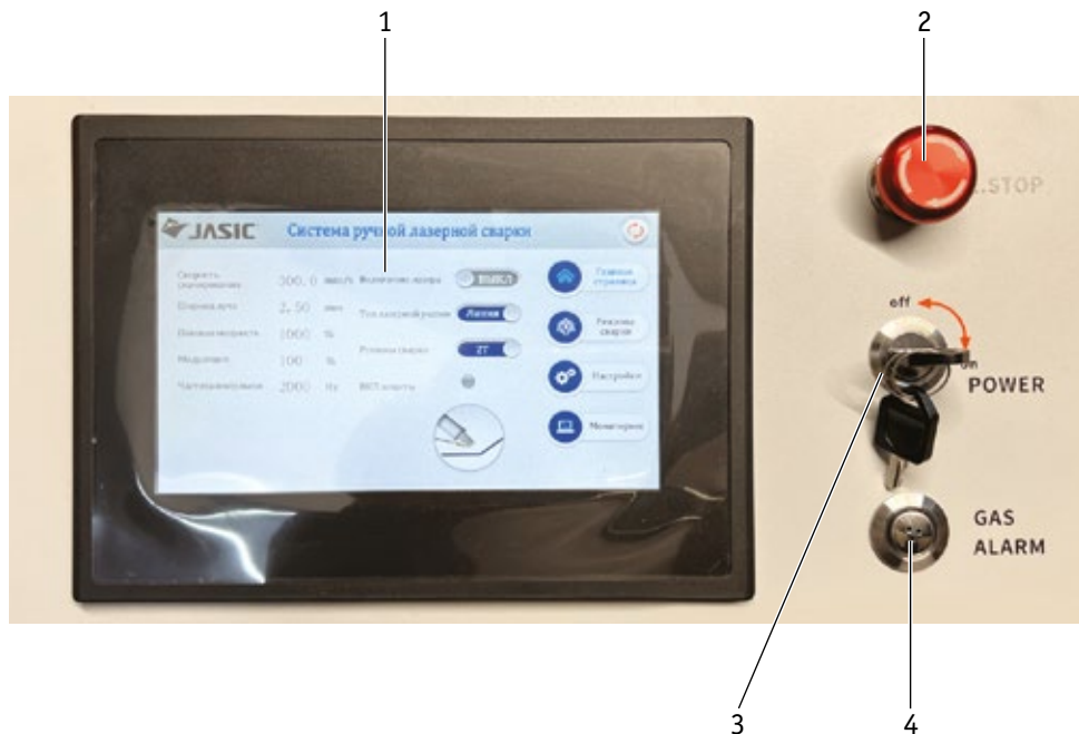
Фото 7.0.1. Панель управления источником.
