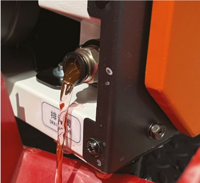
Фото 9.0.4. Слив охлаждающей жидкости.
