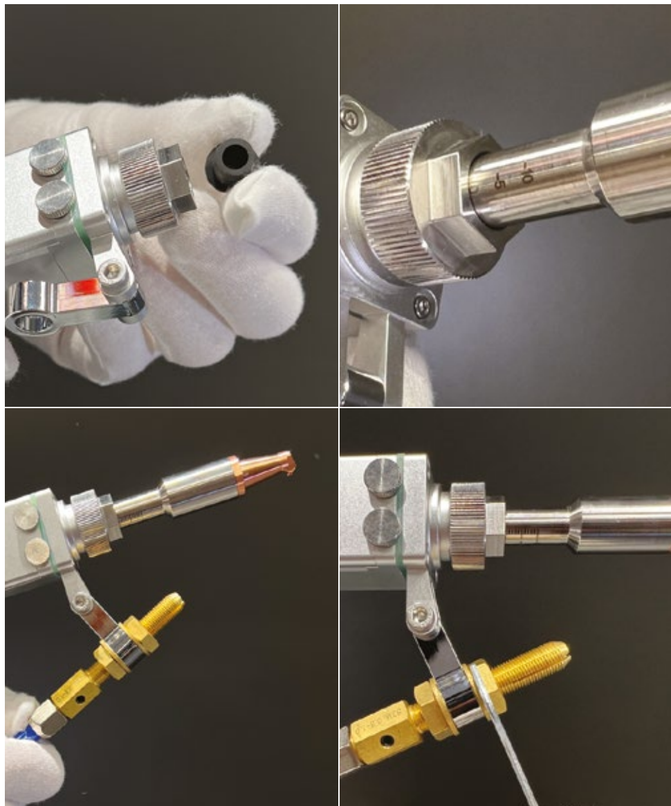
Фото 9.0.11. Сборка сварочной головки.
