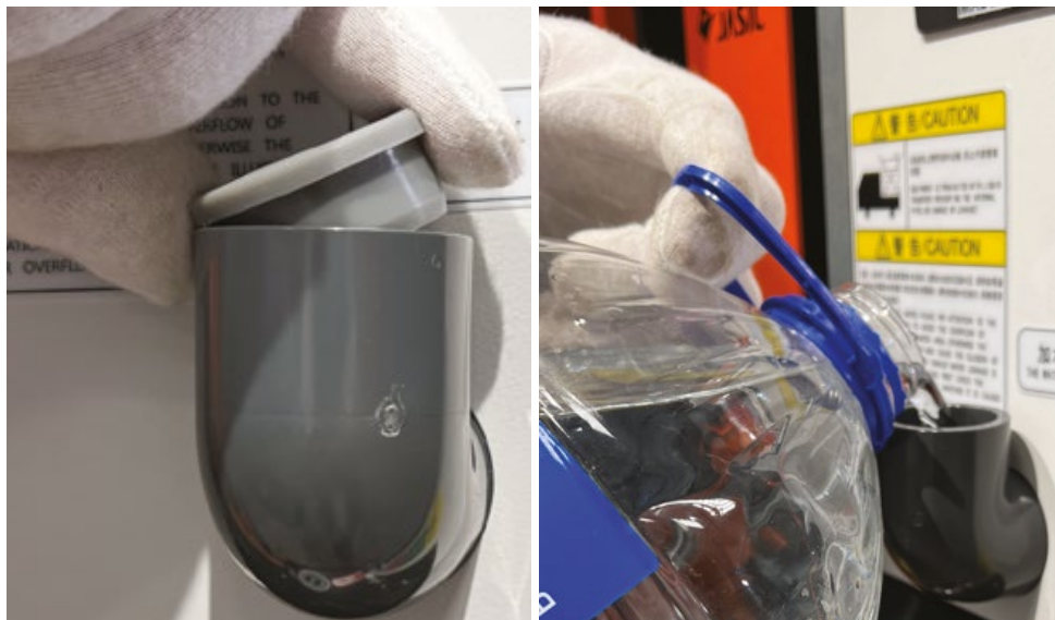
Фото 9.0.3. Заливание охлаждающей жидкости.
