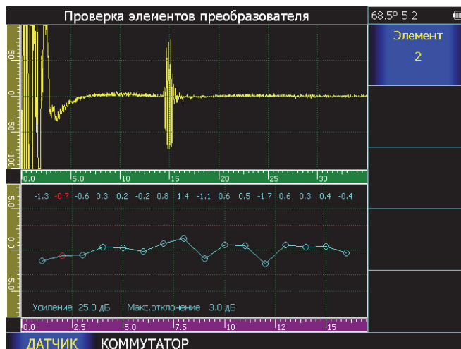
Рис. 5-1 Режим проверки элементов преобразователя с ФАР
