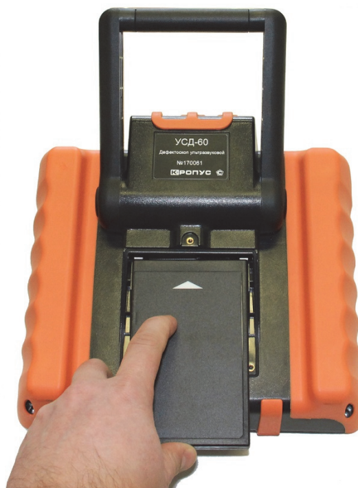
Рис. 1-4 Установка нового аккумулятора
