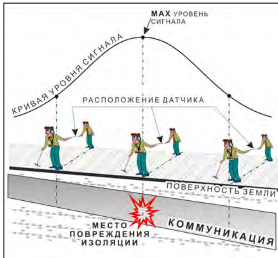
применение датчика-определителя дефектов коммуникации (ДОДК) методом max
