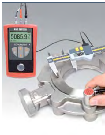
Измерение скорости ультразвука с подключенным суппортом для автоматической передачи данных толщины стенок
