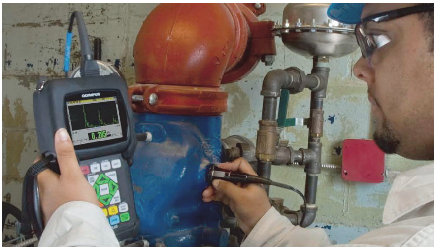
Рис. 1-1 Измерение толщины с помощью 38DL PLUS
