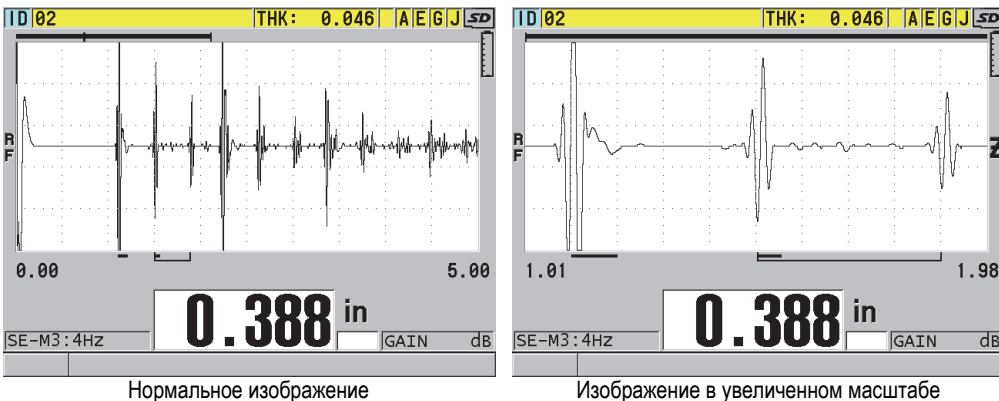
Рис. 4-10 А-скан в обычном и увеличенном масштабе в режиме 3
