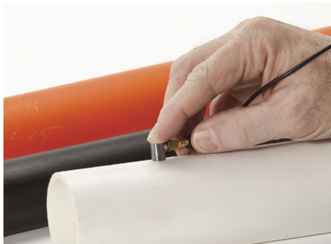
Измерение толщины различных материалов, включая пластмассу, металл, резину, стекло, керамику и композитные материалы.
