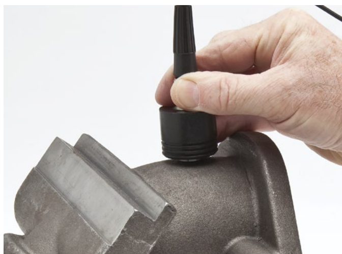
Опция повышенного проникновения для измерения толщины массивных литых деталей или материалов с высоким затуханием ультразвука.
